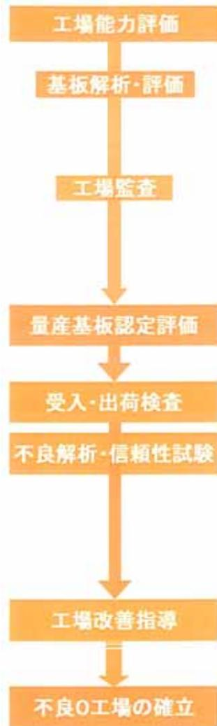
評価目的に応じて評価用試作基板を設計し、基板メーカーや評価対象工場に送付します。各回路間の絶縁信頼性評価・スルーホールやBVHの導通信頼性評価・BGA接合信頼性評価などを評価します。
