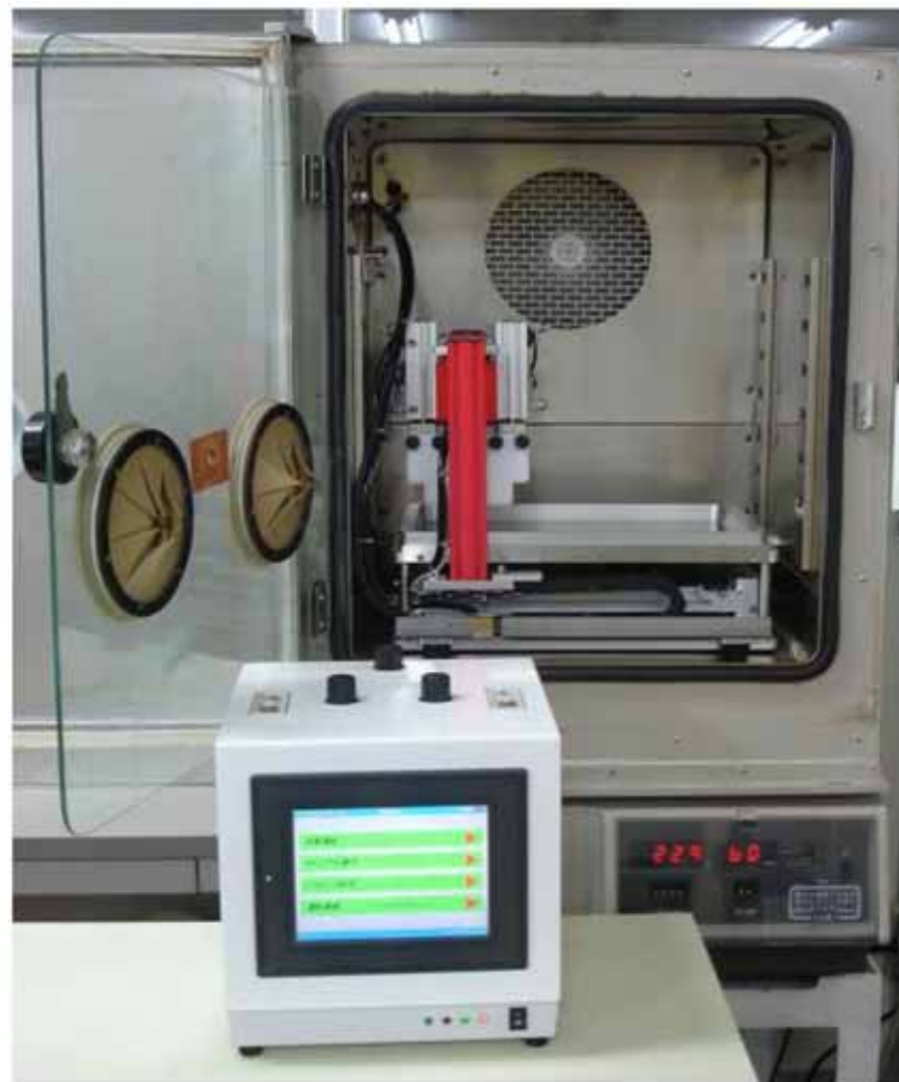
恒温恒湿層へ設置
