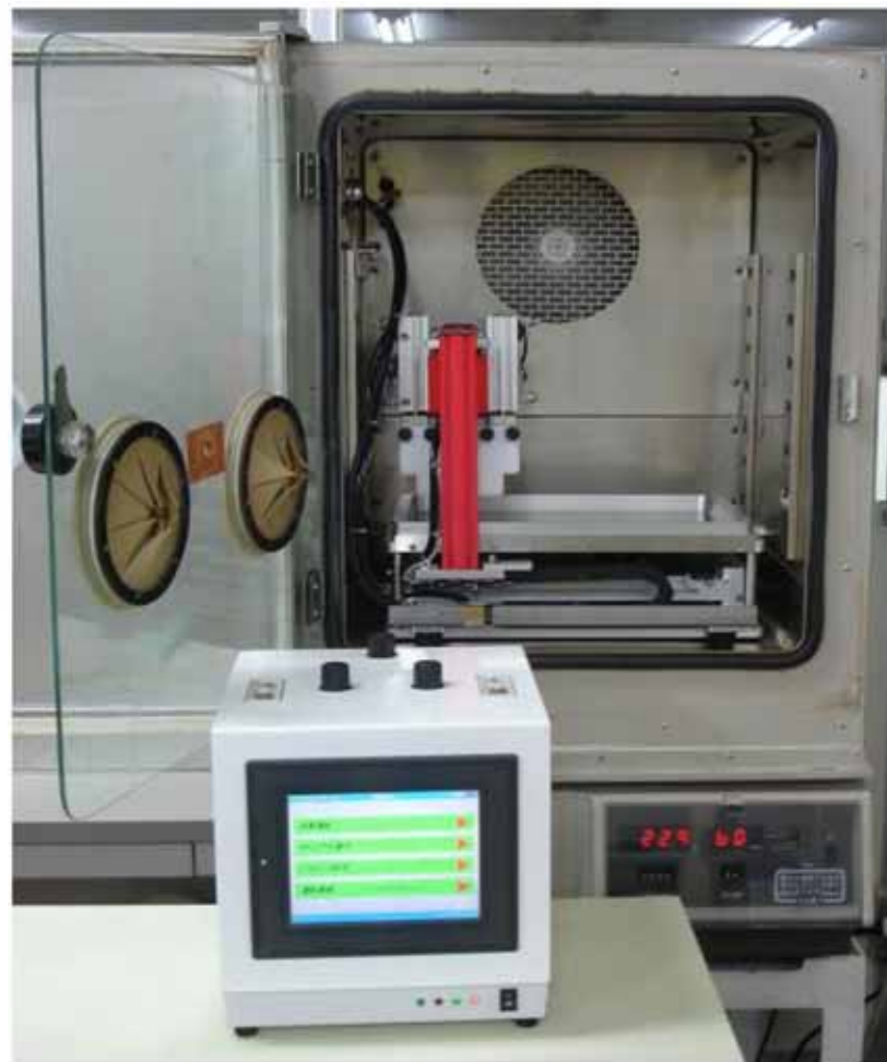
恒温恒湿層へ設置
