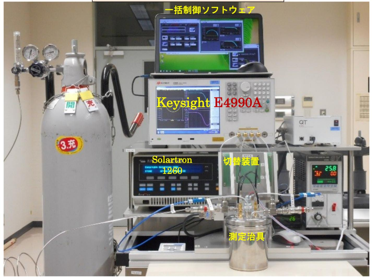
※Solartron 1260と測定治具間の同軸ケーブル長を最短にするため、切替装置をSolartron 1260の端子直前に配置！
