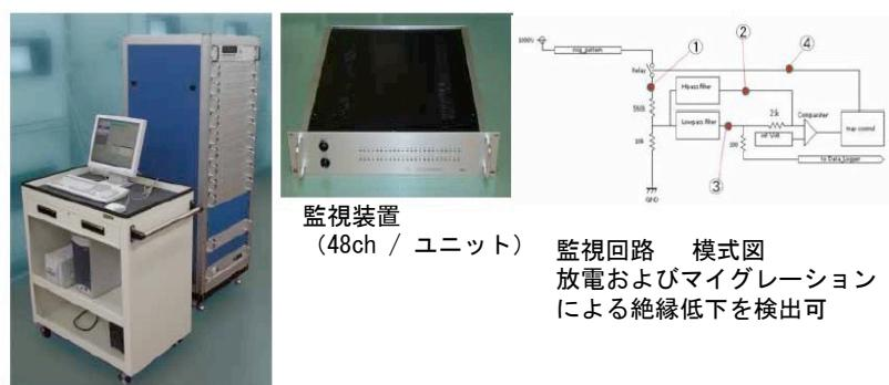
図 1. 高電圧放電・マイグレーション監視装置
