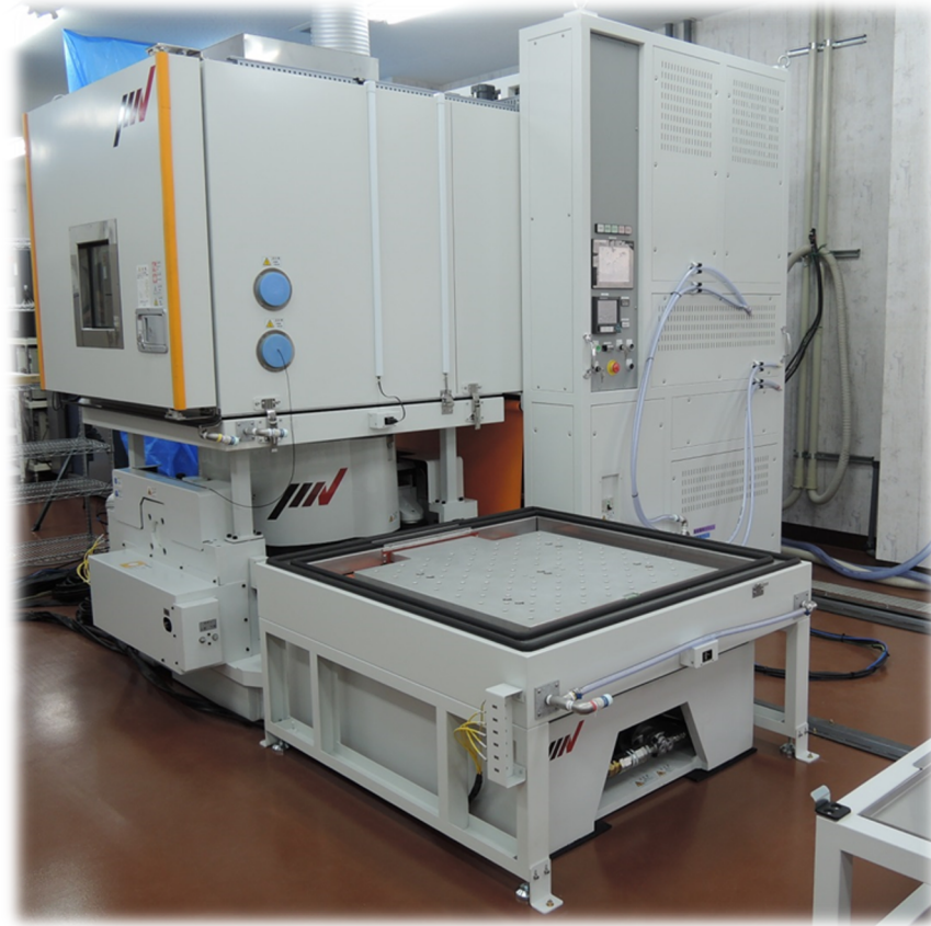
複合振動試験装置(IMV製)
