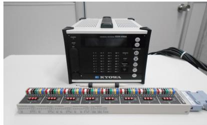
ひずみゲージ用計測器
