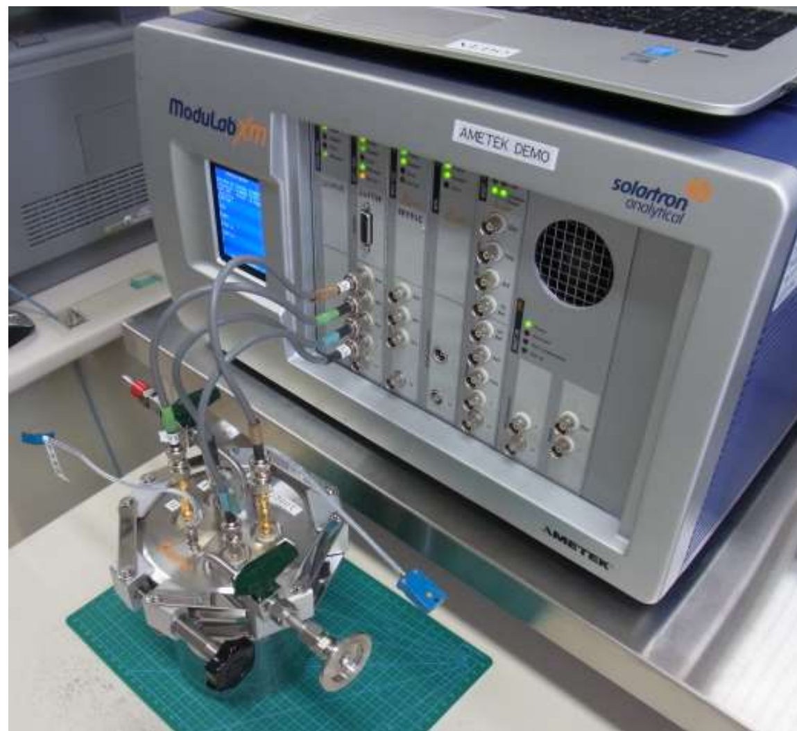
ModuLab XM MTS と測定治具 3 号機との接続
