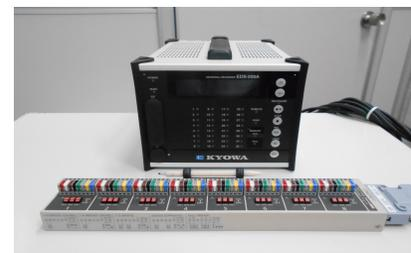
ひずみゲージ用計測器
