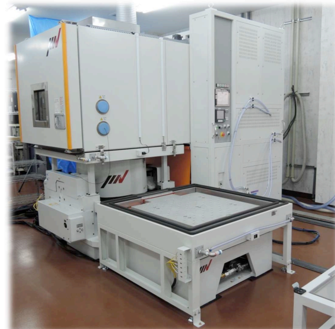
恒温槽付き振動試験機 IMV A30
