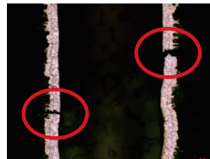
スルーホールクラック
